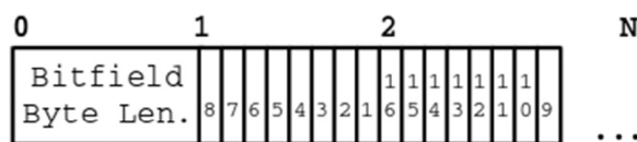
Obr. A.1: Dátová štruktúra NL obsahujúca prvých 16 node ID [2]
