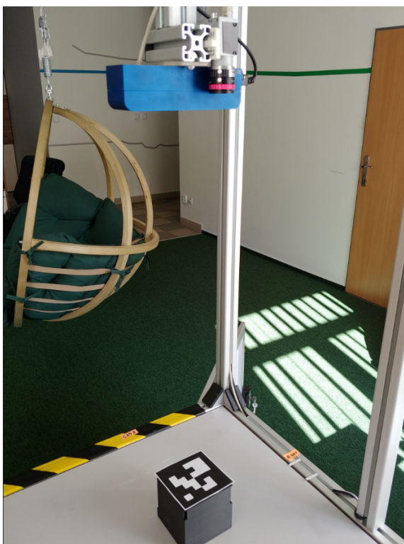
Obrázek 8.12: Umístění 2D kamery ve scéně pracoviště
