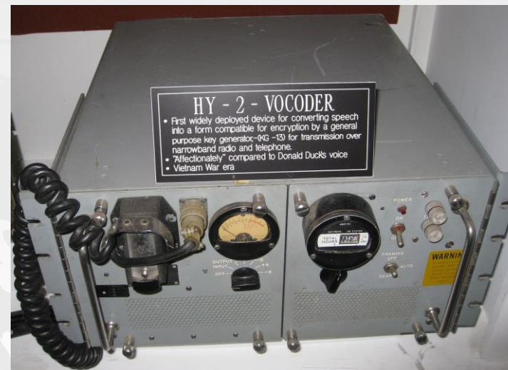
1961 - vokodér pro přenos zašifrované hlasové zprávy přes radio a telefon
