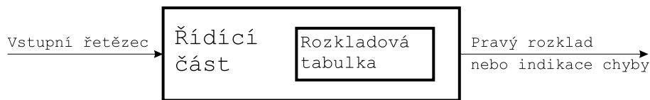
Obrázek 8.3: Schéma LR analyzátoru
