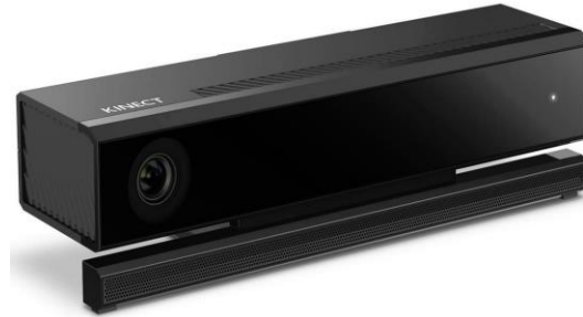
Microsoft Kinect 1. gen. - strukturované světlo 2. gen. - Time of Flight
