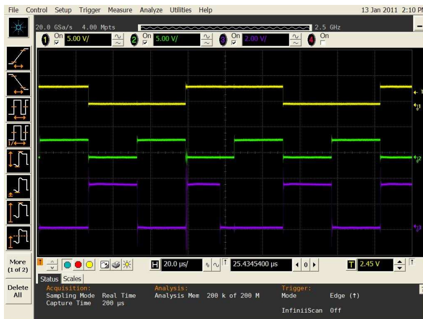
Obrázek 3.20: Hradlo mění funkci z NOR na NOT B při teplotě asi 124^{\circ}\text{C} ( V_{dd} = 3,3 V).
