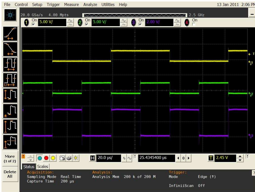
Obrázek 3.21: Hradlo realizuje spolehlivě funkci NOT B při teplotě 125°C ( V_{dd} = 3,3 V).
