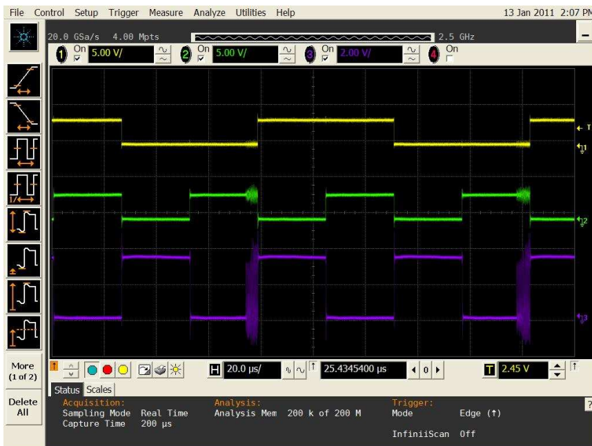
Obrázek 3.22: Hradlo mění funkci na NAND – přechodový děj při teplotě asi 135°C ( V_{dd} = 3,3 V).
