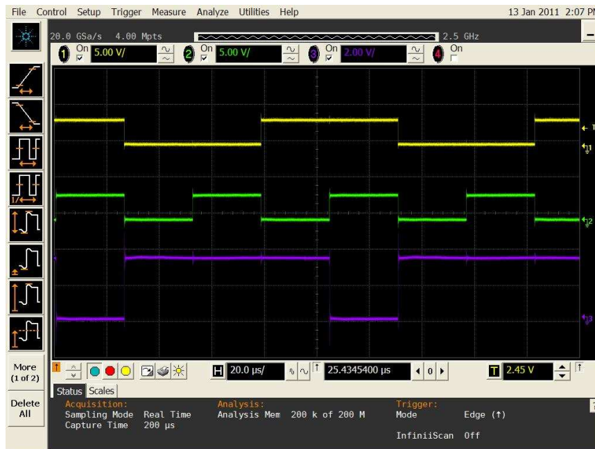
Obrázek 3.23: Hradlo realizující spolehlivě funkci NAND při teplotě 137°C ( V_{dd} = 3,3 V).
