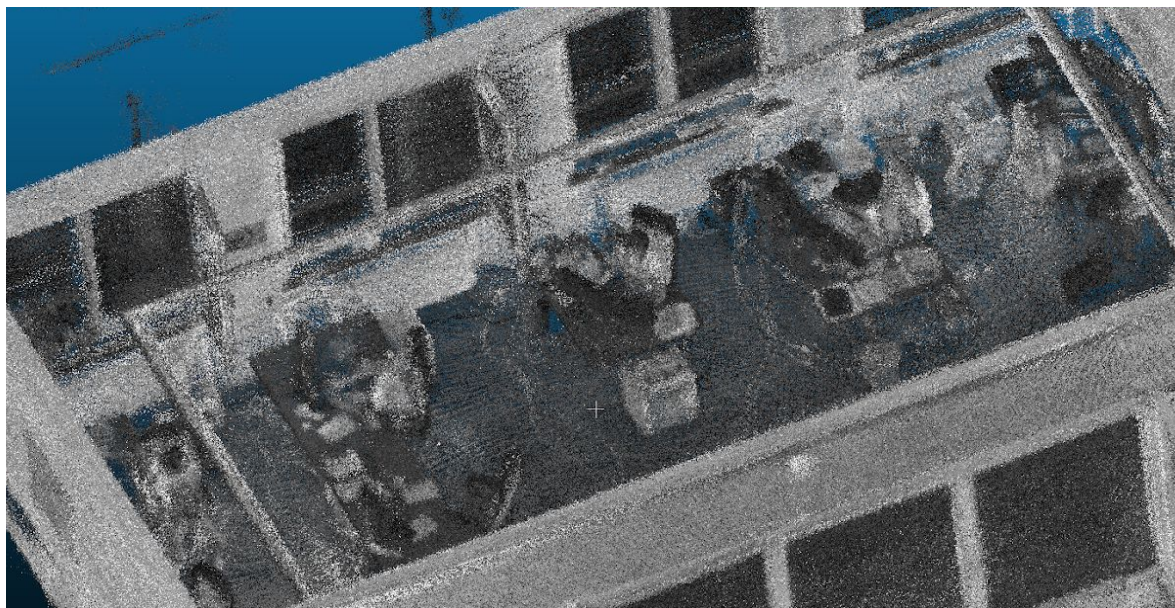
Obrázek 1: Příklad scény nasnímané senzorem LiDAR a obarvené energií laserového paprsku.
