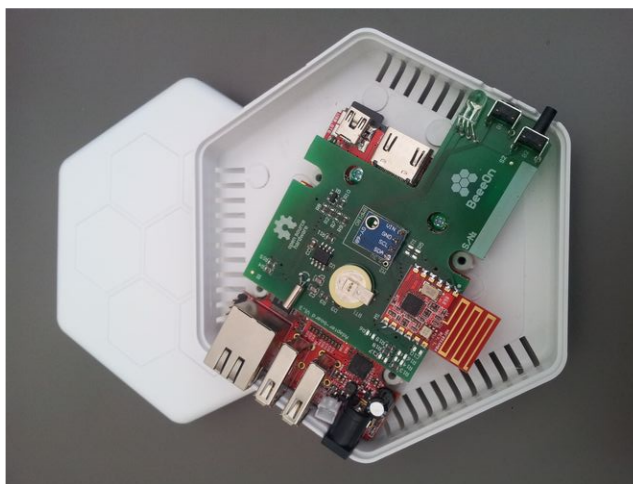
Snímek č. 3: BeeOn adaptér a jeho platforma OLinuXino s rozšiřující rádiovou deskou.
