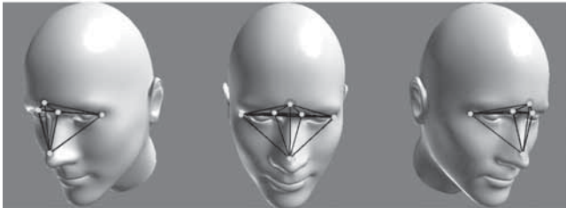
Abbildung 2.2 | Beispiel für die nodalen Gitterpunkte auf dem Gesicht aus unterschiedlichen Winkeln
