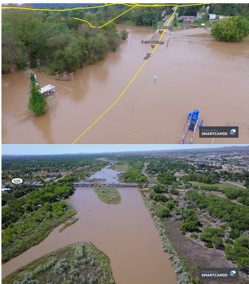
Obrázek 3: Nahoře: Augmentace obrazu z kamery dronu geografickými daty silnic. Využití například při záplavách. Dole: Vyznačení významných míst v obrazu kamery dronu (zdroj: https://www.youtube.com/watch?v=DOVPXmuaPNI ).
