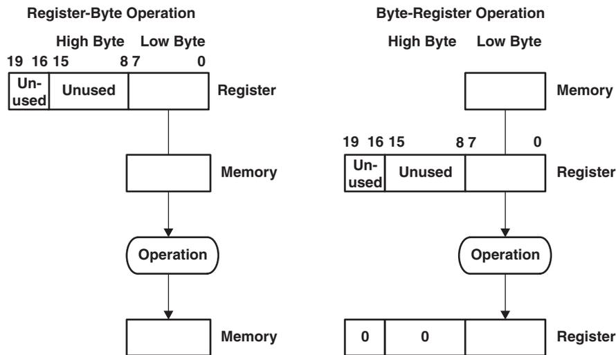
Figure 4-10. Register-Byte/Byte-Register Operation
