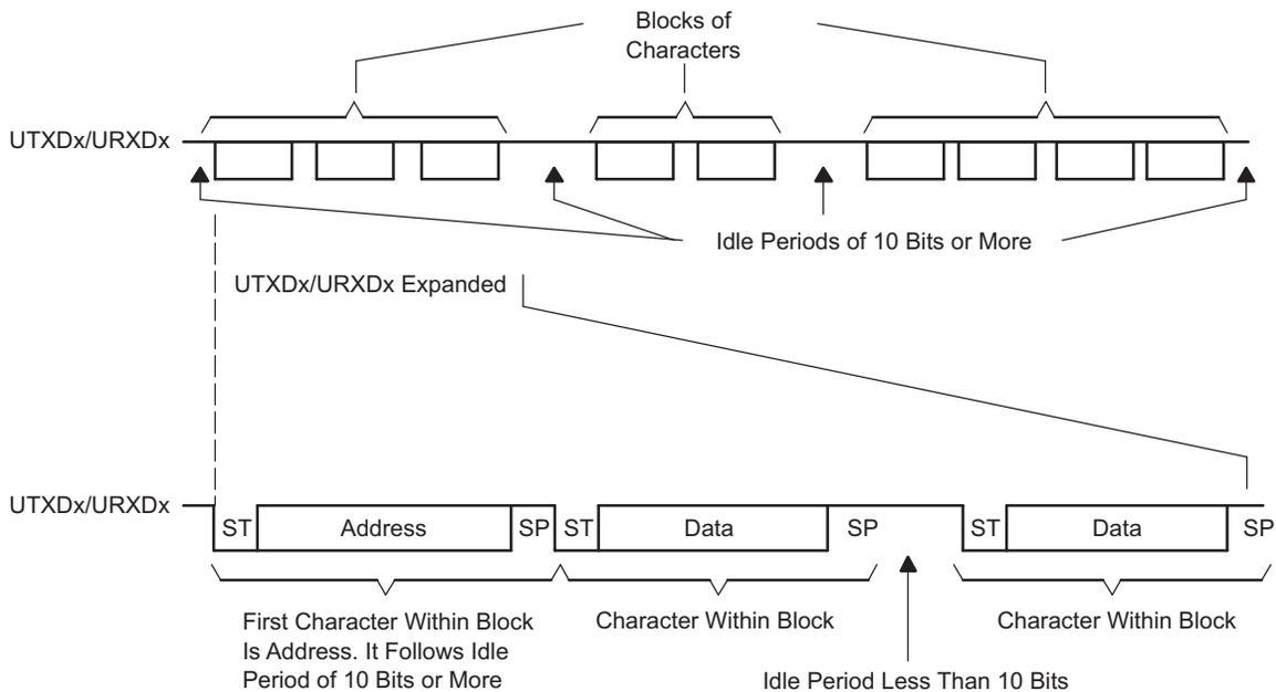
**Figure 18-3. Idle-Line Format**
