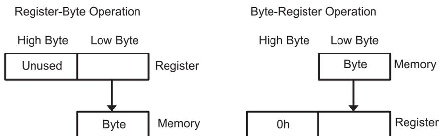
Figure 3-7. Register-Byte/Byte-Register Operations
