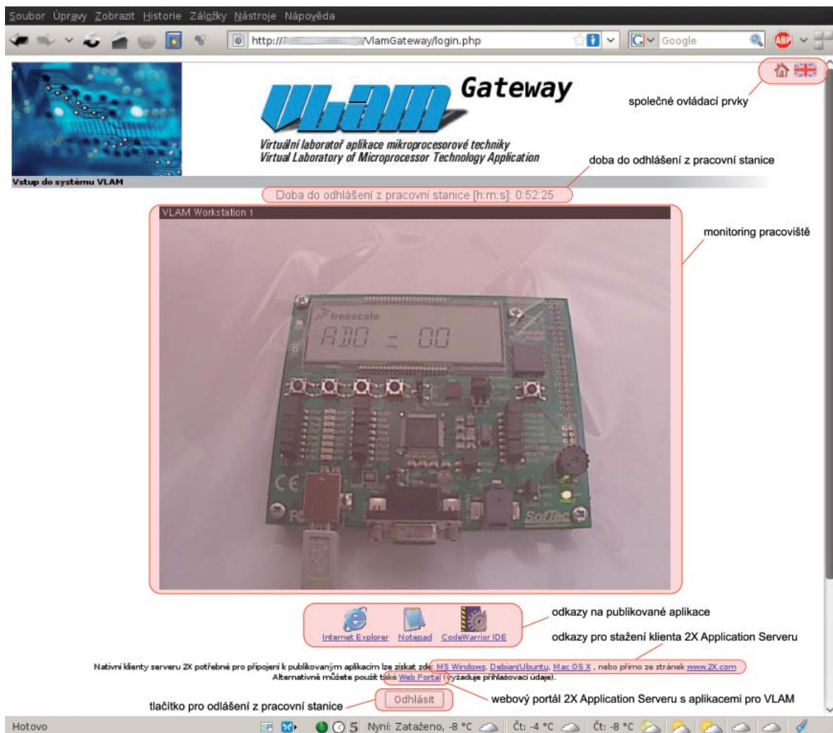
Obr. 10: Rozložení ovládacích prvků na pracovní ploše webové aplikace
